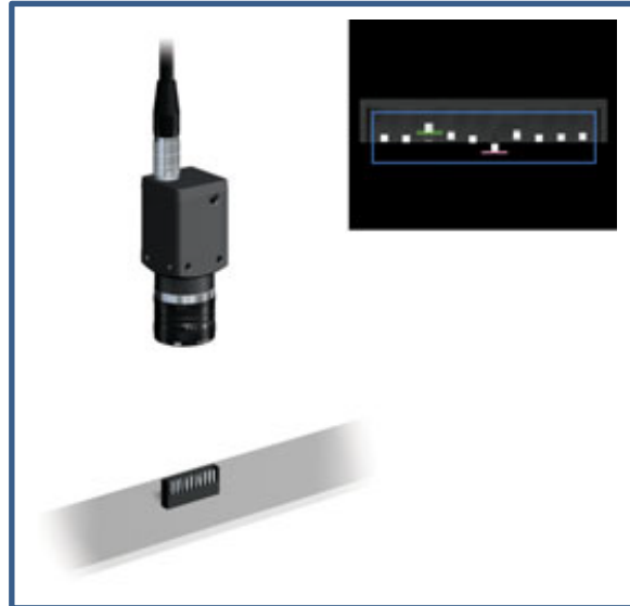
Slika 3: Mjerenje komplanarnosti pinova na konektoru.[7]
