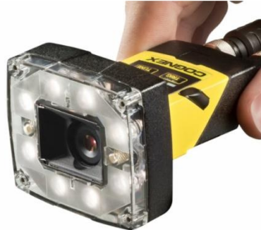
Slika 72: Kompaktni fotoaparata za strojni vid. [1]
