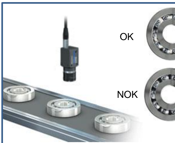
Slika 5: Kontrola prisutnosti maziva u položajniku.[7]
