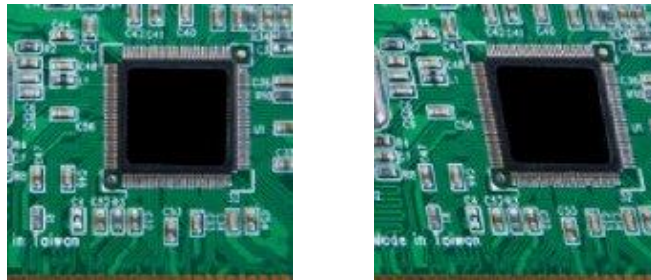
Slika 70: Lijevo – slika snimljena globalnim zatvaračem. Desno – slika snimljena rolling zatvaračem.[2]
