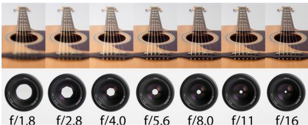
Slika 48: Utjecaj otvorenosti aperture na oštrinu slike.[10]
