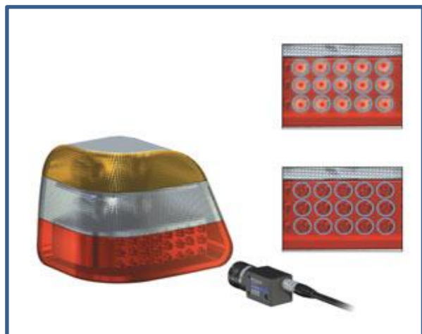
Slika 6: Kontrola osvjjetljenja LED svjetla.[7]
