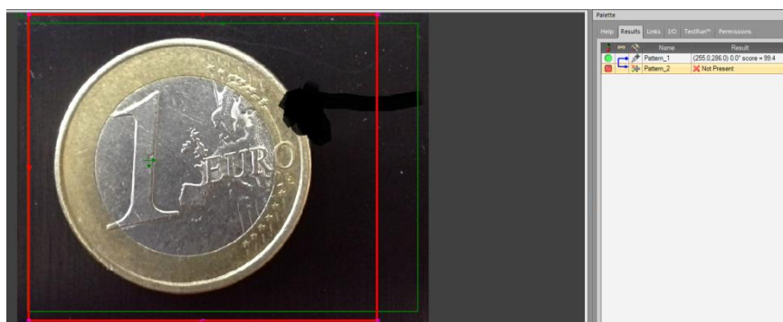
Slika 88: Prepoznavanje oštećenog ruba kovanice.
