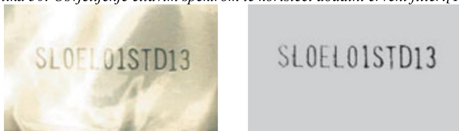
Slika 51: Promjena osjetljenja može povećati mogućnost raspoznavanja natpisa na desnoj slici.[7]
